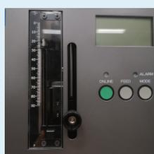
通过调节位于前面板的试管支架,可以改变标签的粘贴高度。
